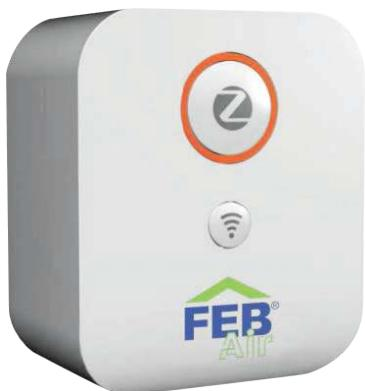
Il centro di tutta la domotica FEB Air: dialoga con protocollo ZigBee con i moduli e via Wi Fi con il router di casa o lo smartphone. Si collega automaticamente al cloud per gestire la casa anche quando siete lontani.
