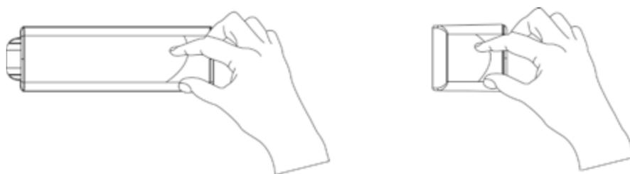
Avere cura di pulire la superficie di installazione prima di applicare il sensore ed il contatto mobile.
