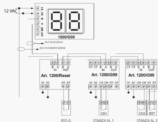
Schema di cablaggio a due chiamate tra quadro digitale art. 1600/G99 e concentratore di camera art. 1200/G99, con attivazione diretta del segnalatore di emergenza art. 1200/2.
