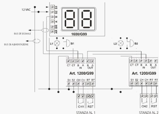
Schema di cablaggio a due chiamate tra quadro digitale art. 1600/G99 e concentratore di camera art. 1200/G99, con reset generale art. 1200/Reset.
