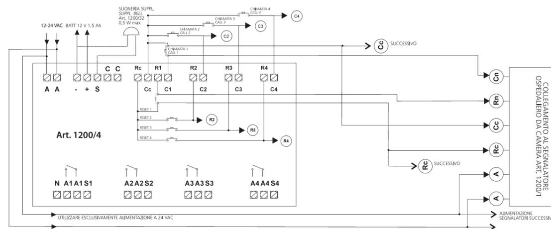
Schema di cablaggio a due chiamate tra quadro digitale art. 1600/G99 e concentratore di camera art. 1200/G99, con reset generale art. 1200/Reset.
