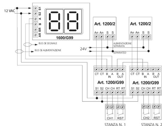
Schema collegamento quadro a led a un solo ripetitore 1200RIP/4
